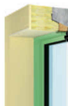
Isolation thermique par l'extérieur (ITE)
